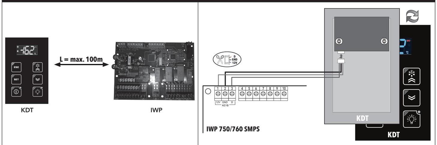
**ATTENZIONE:** Se la tastiera viene collegata a una base della famiglia **RTX-RTD-RTN 400 e 600 (V)**, è NECESSARIO configurare i seguenti parametri: **H33 = 0** e **H35 = 6**.
